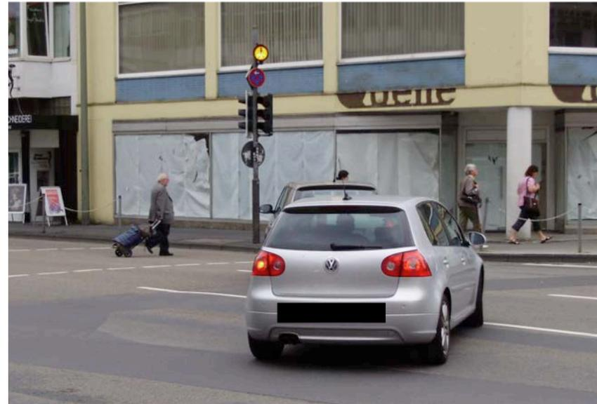
„Die nicht gesicherte Führung der Linksabbieger sollte nur bei geringer Stärke mindestens eines der beiden Fahrzeugströme angewendet werden.“
